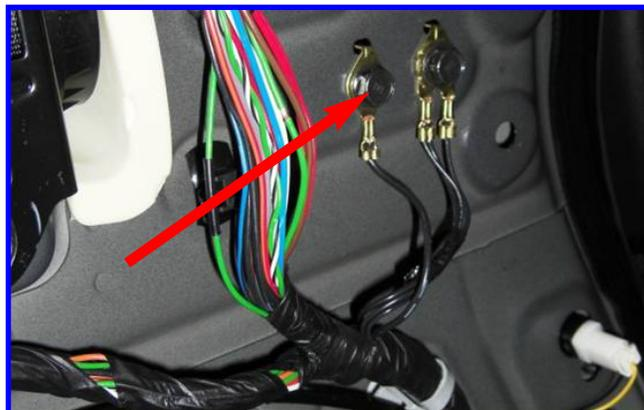
**NOTE :** Le connessioni dovranno essere eseguite con saldatura del cavo o crimpatura e isolate tramite guaina termoretraibile o nastro isolante.
