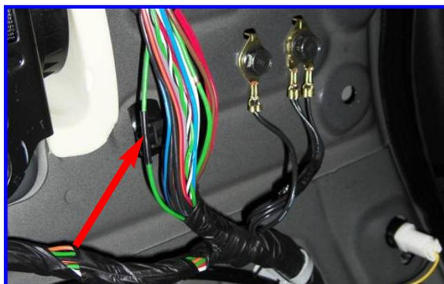
**NEGATIVO:** Per il collegamento elettrico individuare la diramazione di massa originale posta nel baule dietro la paratia posteriore lato guida.
