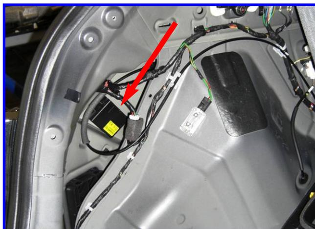
**SEGNALATORE ACUSTICO** : Fissare il segnalatore acustico (buzzer) sul fianco baule lato guida, dietro la paratia plastica di copertura cintura di sicurezza.
